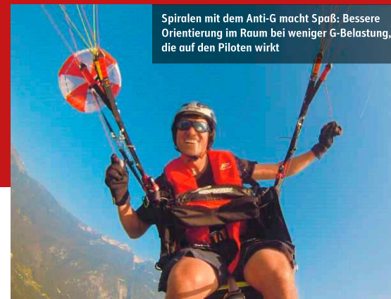
Das Anti-G: höheres Sinken pro Spiraldrehung bei reduzierten G-Belastungen
