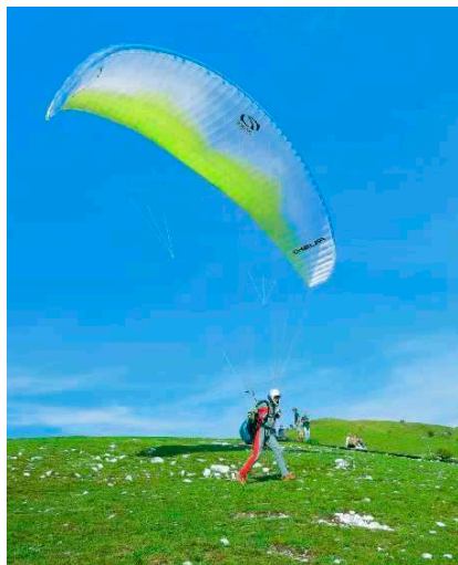
Zuerst werden beide Bremsen bis ca. Brusthöhe gezogen und dabei das Geh-Tempo noch nicht verringert, um die Kappe nach hinten nicken zu lassen und damit den Widerstand zu erhöhen.
