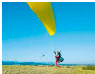
Stabilisierungsphase: der Pilot hat rechtzeitig die Bremsen eingesetzt, um die auf ihn zukommende Kappe abzubremesen. Gleichzeitig macht er ein bis zwei Schritte rückwärts in Startrichtung und steuert so aktiv, dass die Kappe senkrecht über ihm bleibt.
